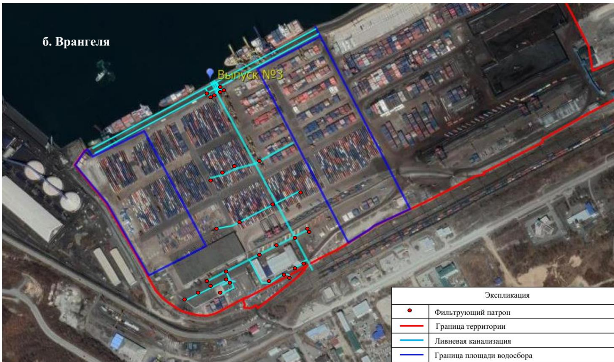
План территории организации, эксплуатирующей водосбросные сооружения (выпуск №3 ООО «ВСК»), с наложением сетей ливневой канализации и указанием места размещения очистных сооружений
