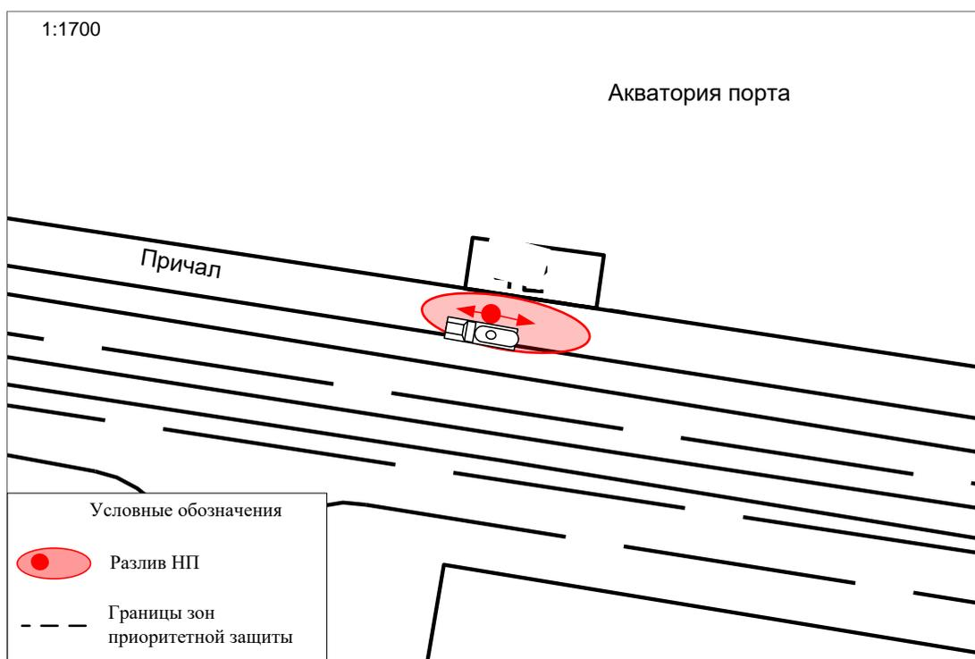
Рисунок 3.10.2-1. Схема сценариев при разгерметизации автоцистерны на маршруте следования
