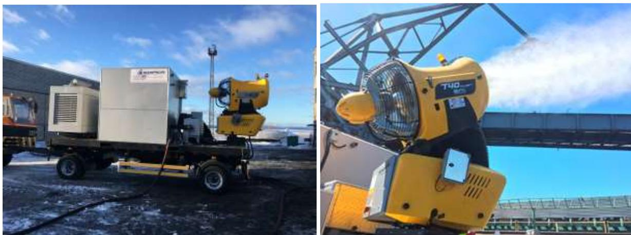
Рисунок 3.2.6-2 Установка пылеподавления
