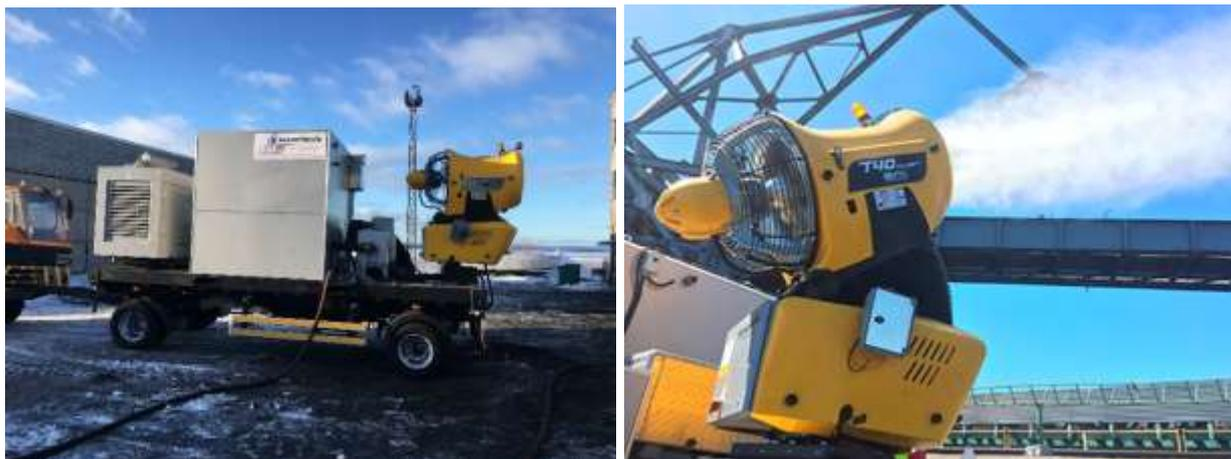
Рисунок 2.2.3-2 Установка пылеподавления
