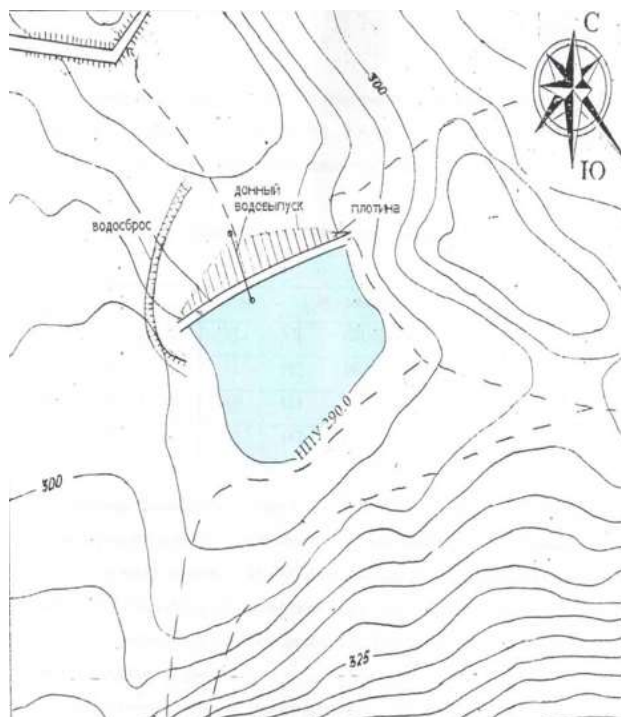
Рисунок 6.1 – Генплан пруда «Подгорный» (М 1 : 5000)
