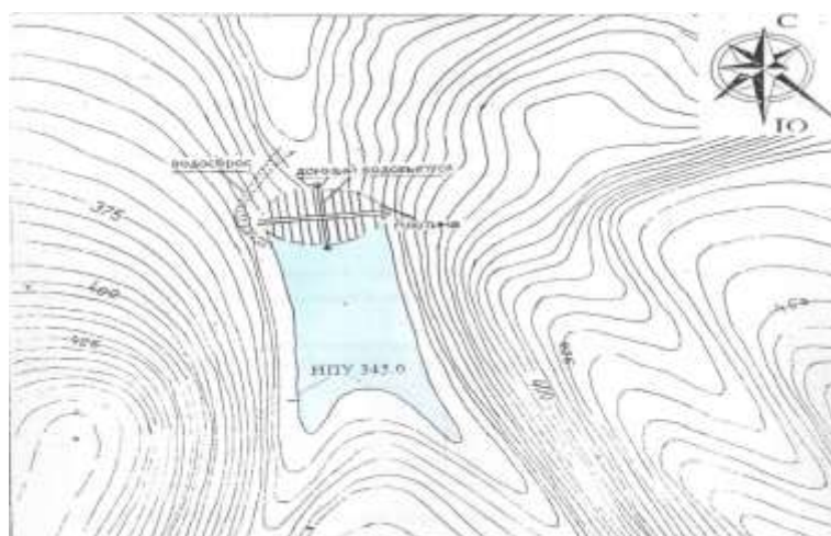
Рисунок 14.1 – Генплан пруда «Лиманский» (М 1 : 5000)
