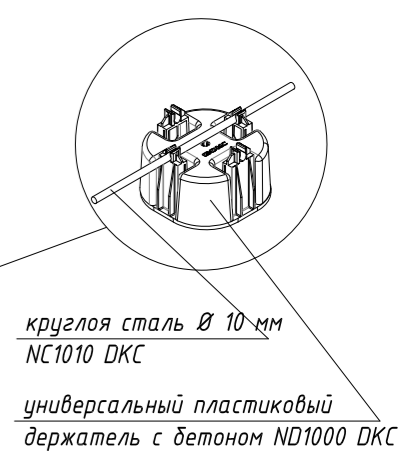
Установка молниеприемной сетки на кровле
