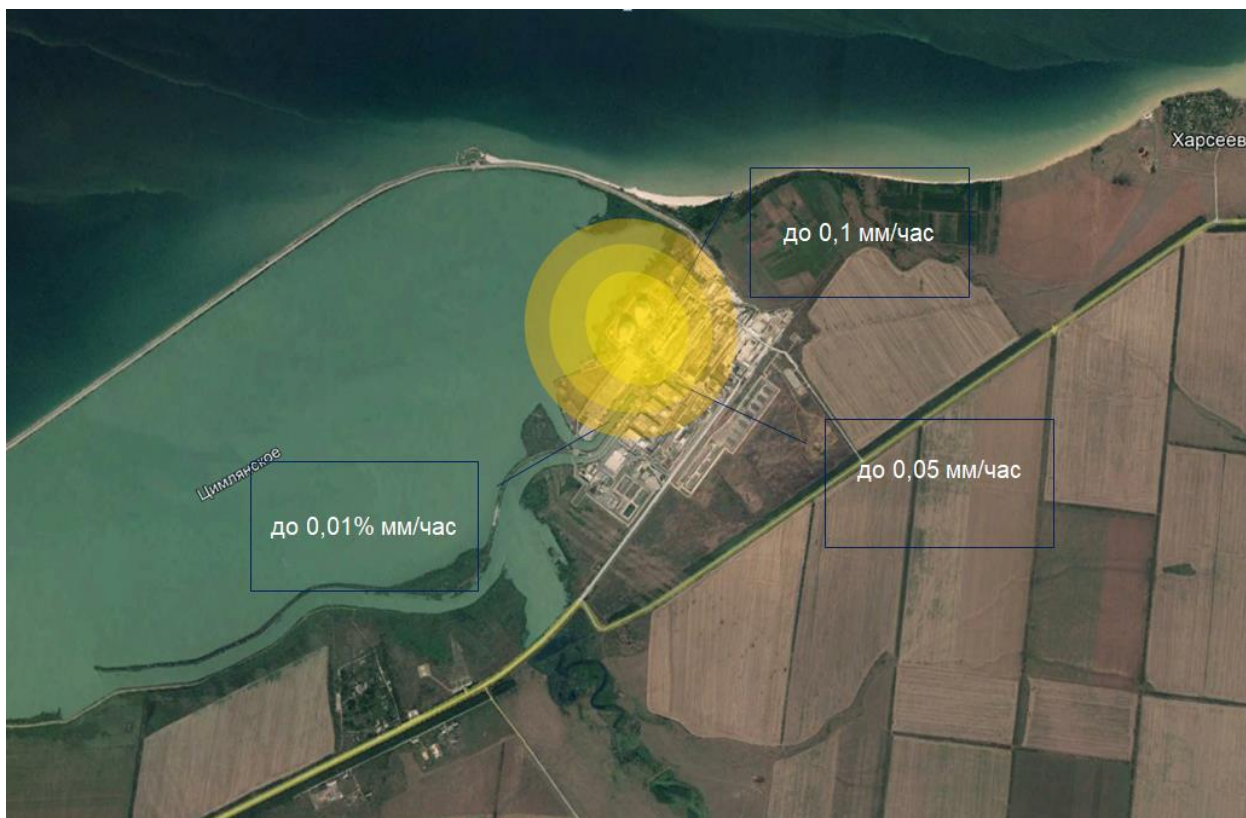
Рисунок 12.3.6 – Расчетная интенсивность осадения воды (мм/час) в среднем в зимний период от комплекса БИГ и ВИГ на площадке Ростовской АЭС
