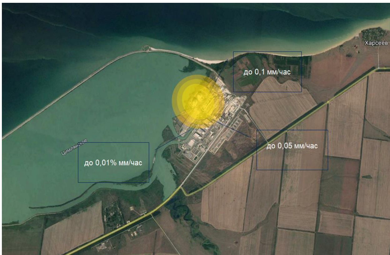
Рисунок 12.3.5 – Расчетная интенсивность осаднения воды (мм/час) в среднем в летний период от комплекса БИГ и ВИГ на площадке Ростовской АЭС
