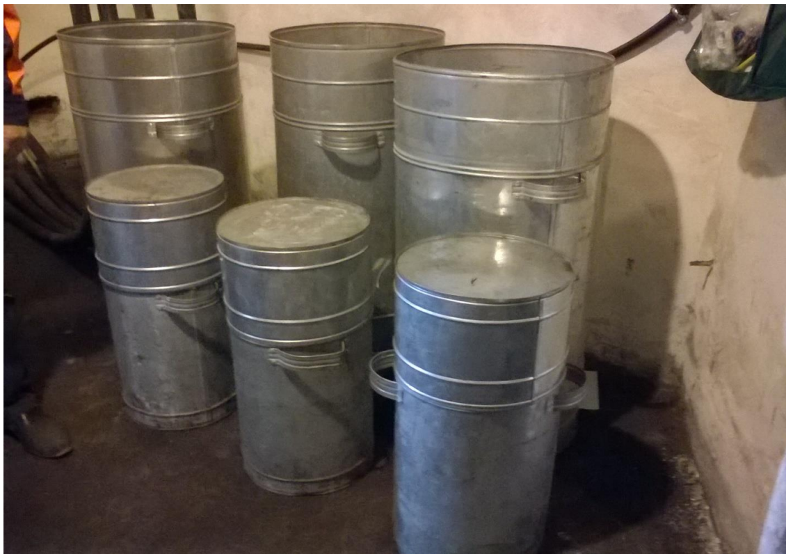
Рисунок 2.19 – Тара для накопления и транспортирования отработанных ртутных ламп
