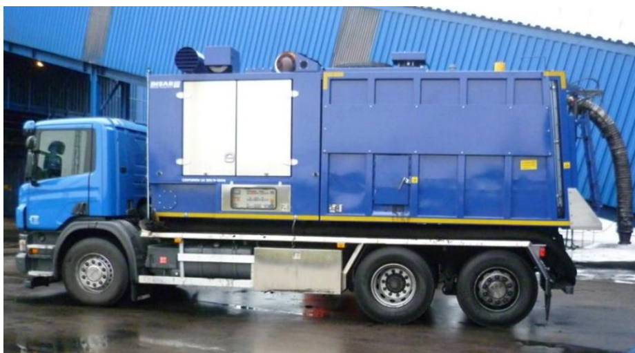
Рисунок 2.16 – Вакуумный погрузчик Centurion L 200 на базе Skania
