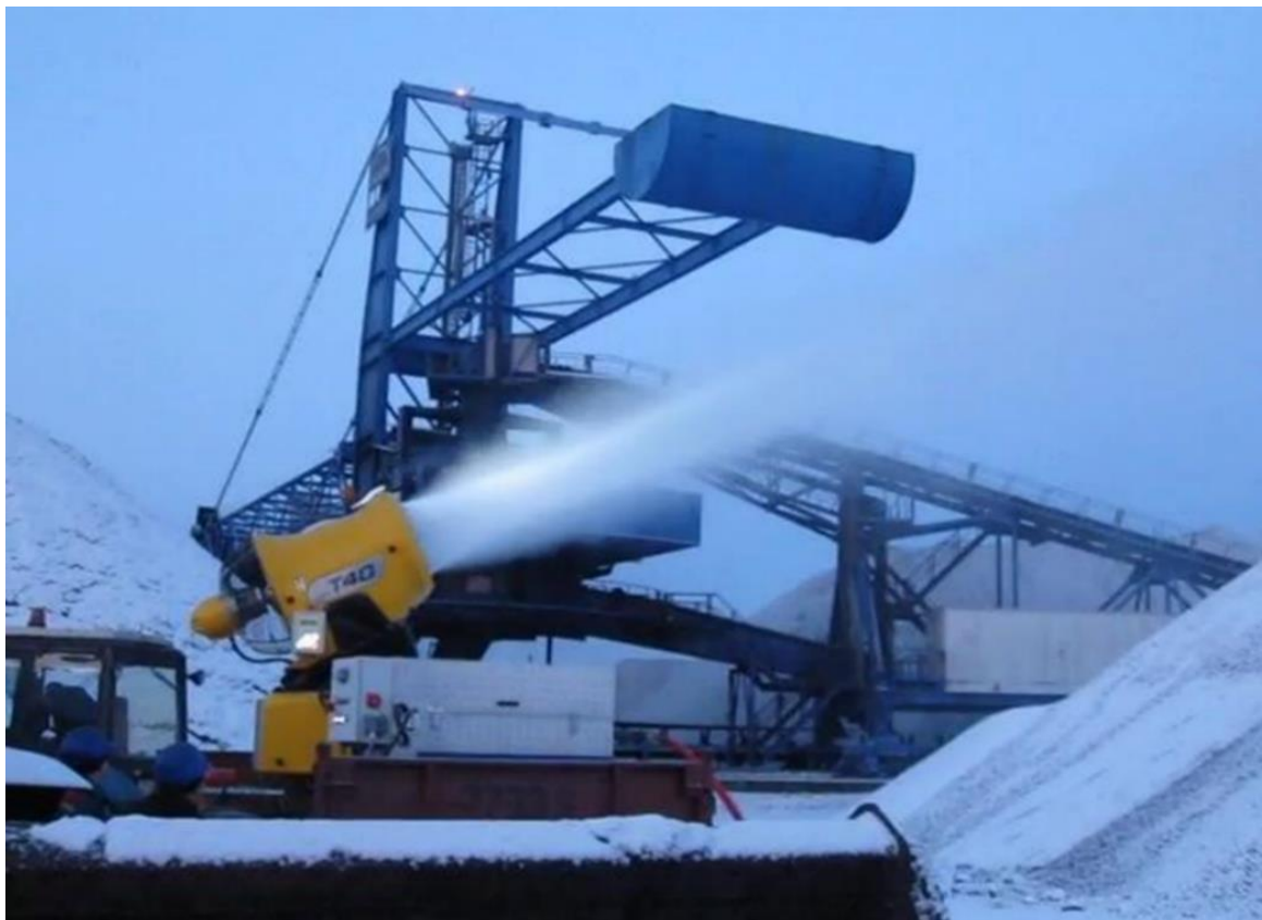
Рисунок 2.7 – Снегогенераторная установка на базе модели TechnoAlpin T40A (Италия) для пылеподавления в зимний период
