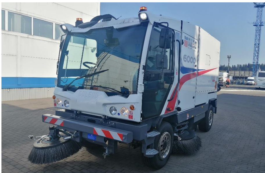
Рисунок 2.17 – Подметально-уборочная машина Dulevo 6000 (МАРС)
