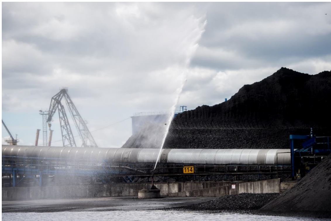
Рисунок 2.14 – Ветрозащитная конструкция в виде кожуха
