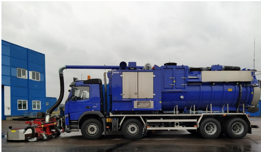
Рисунок 2.15 – Вакуумный погрузчик Centurion LN 10 на шасси Volvo FM-380
