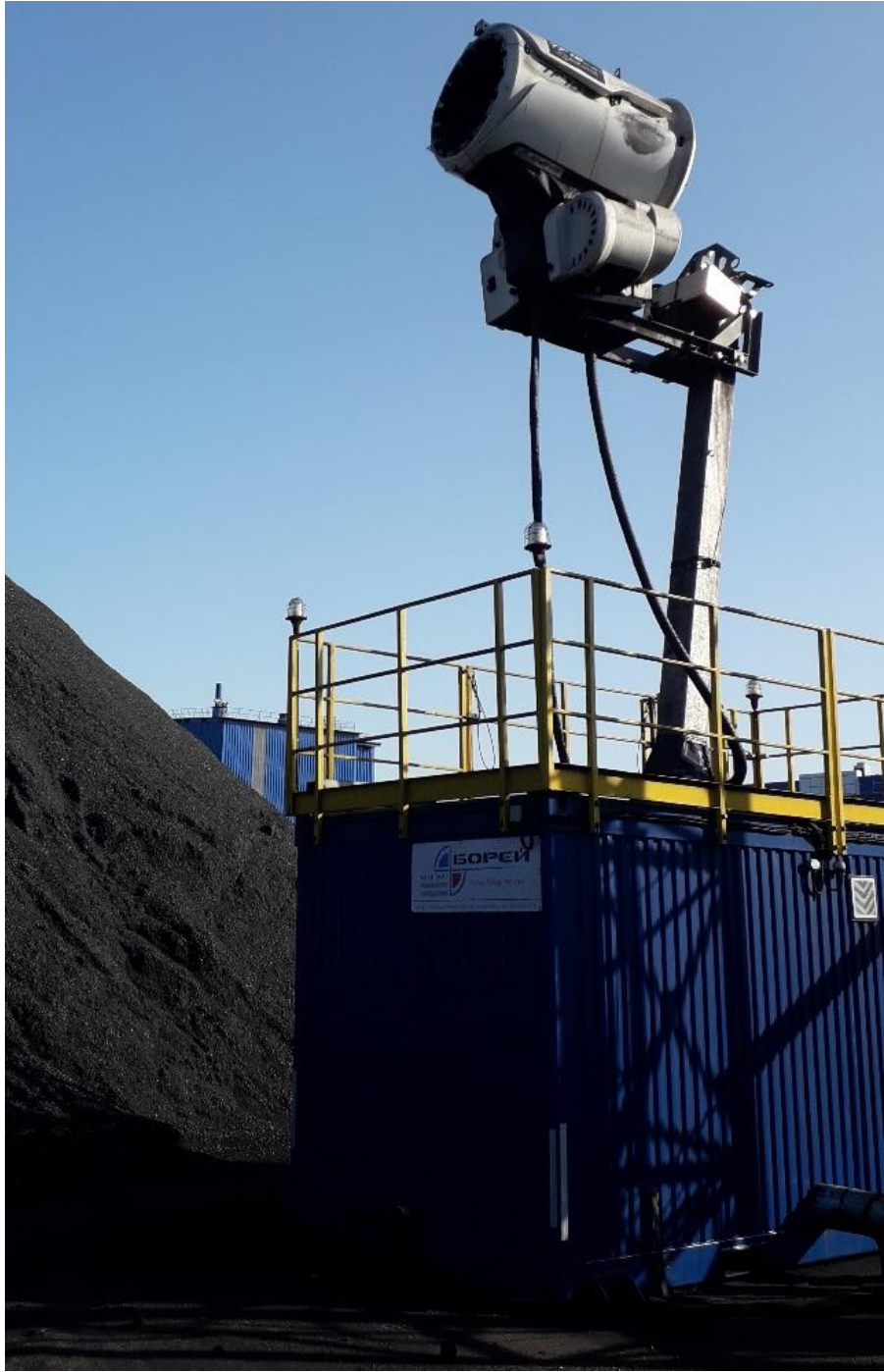
Рисунок 2.6 –Стационарная снегогенераторная установка для пылеподавления
