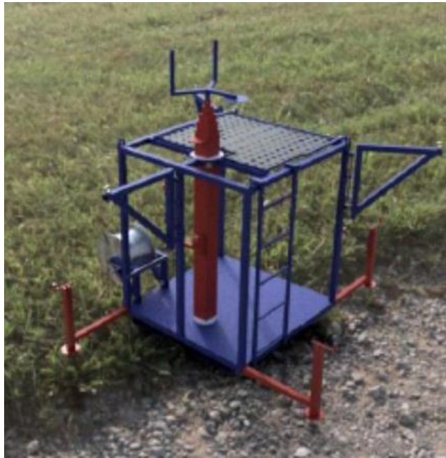
Рисунок 7.8- Мобильная базовая станция «Куб»
