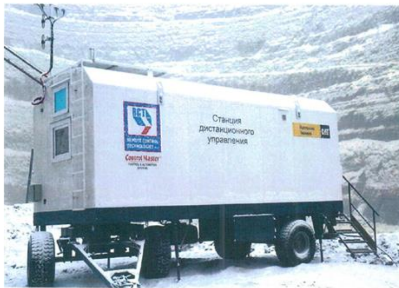
Рисунок 7.11- Передвижная станция дистанционного управления
