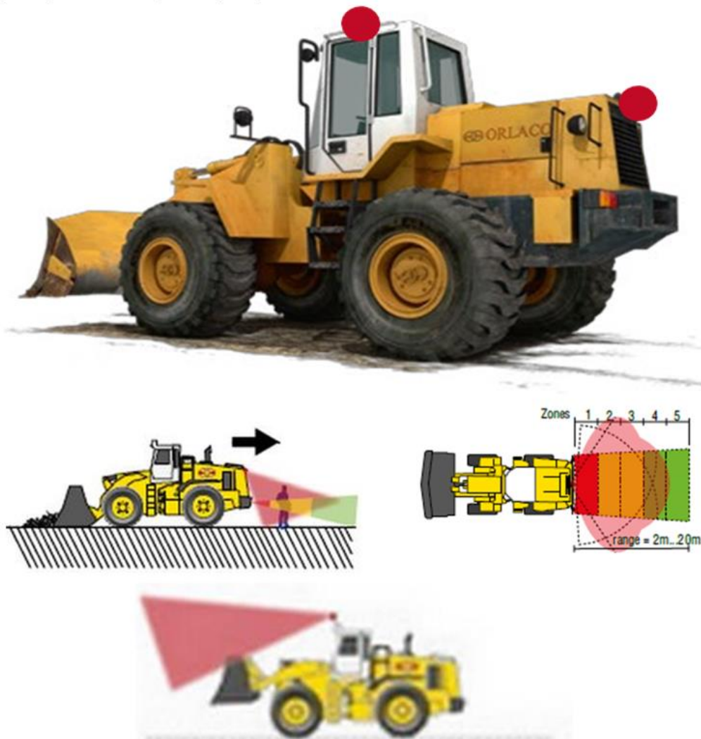
Рисунок 7.22- Установка оборудования на фронтальный погрузчик
