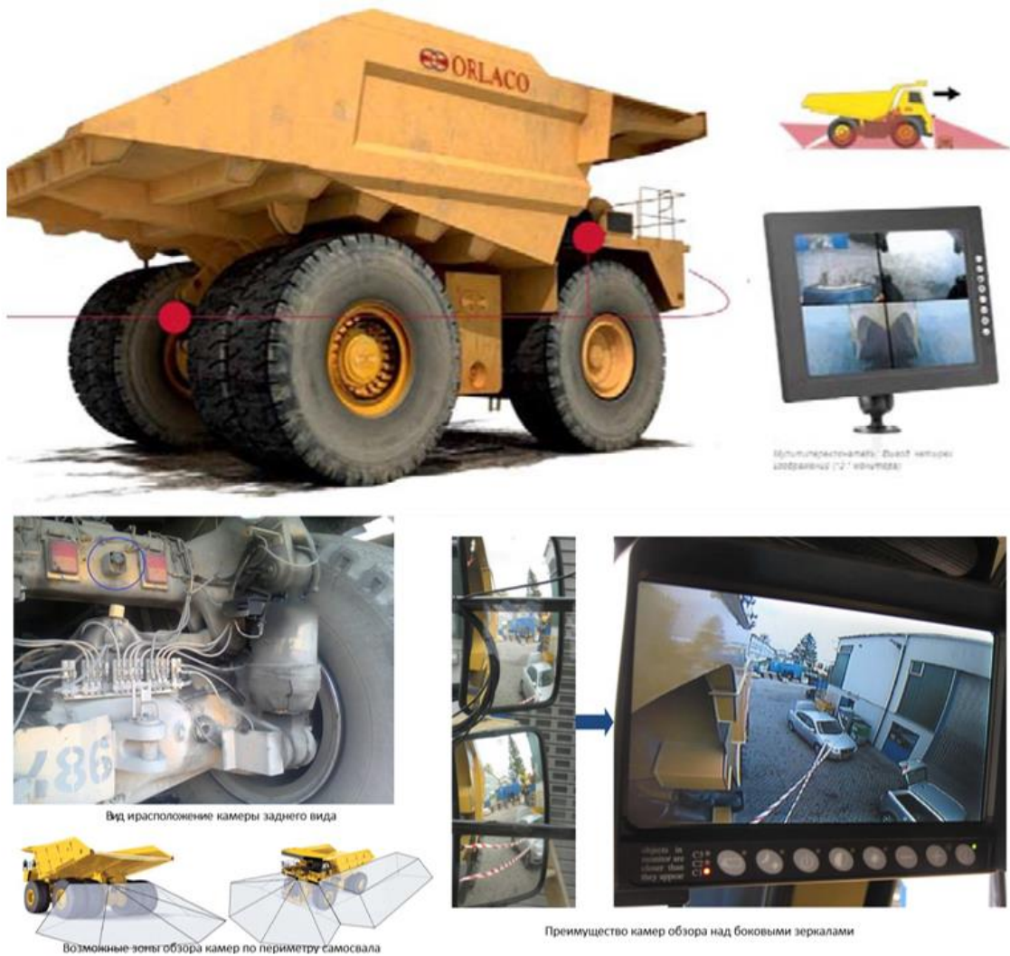
Рисунок 7.17- Установка оборудования на автосамосвале 90-220 тонн
