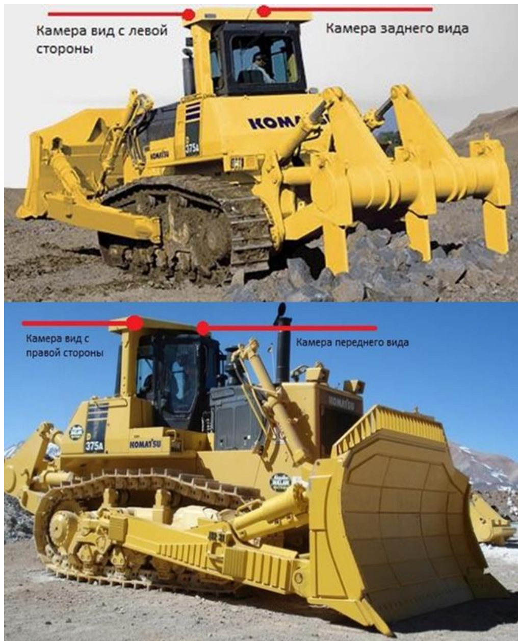
Рисунок 7.23- Установка оборудования на бульдозер
