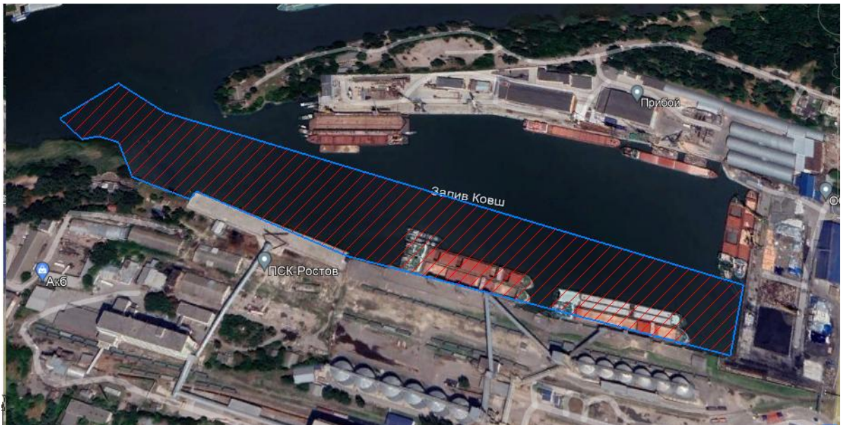
Рисунок 4.4 – Область расчистки 54215 м 2 (средняя ширина места расчистки 77,45 м)
