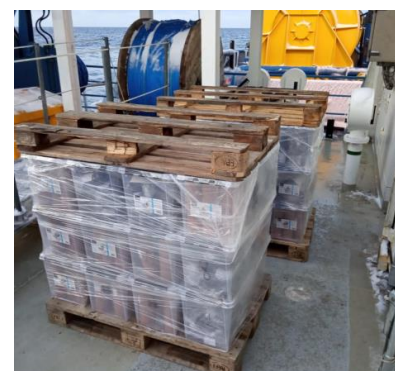
Рисунок 3.6-5. Пример упаковки образцов керна для отправки в лабораторию
