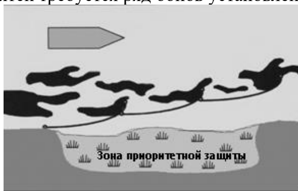
Рисунок 11.4-2. Отвод нефтяных пятен болами, установленными каскадами
