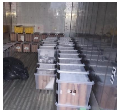
Рисунок 1.3-4. Рефрижераторный контейнер для хранения образцов керна
