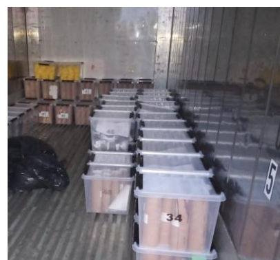
Рисунок 3.6-4. Рефрижераторный контейнер для хранения образцов керна
