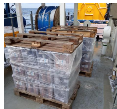
Рисунок 2.4-5. Пример упаковки образцов керна для отправки в лабораторию
