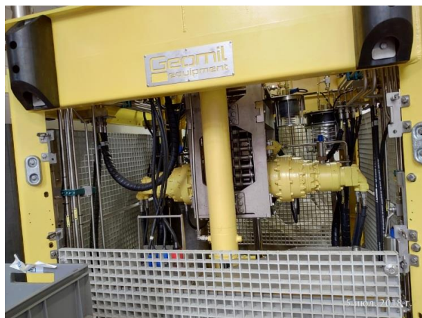
Рисунок 1.3-2. Установка статического зондирования «Manta 200 DW»
