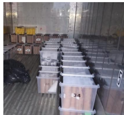
Рисунок 2.4-4. Рефрижераторный контейнер для хранения образцов керна
