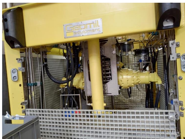
Рисунок 3.6-2. Установка статического зондирования «Manta 200 DW»
