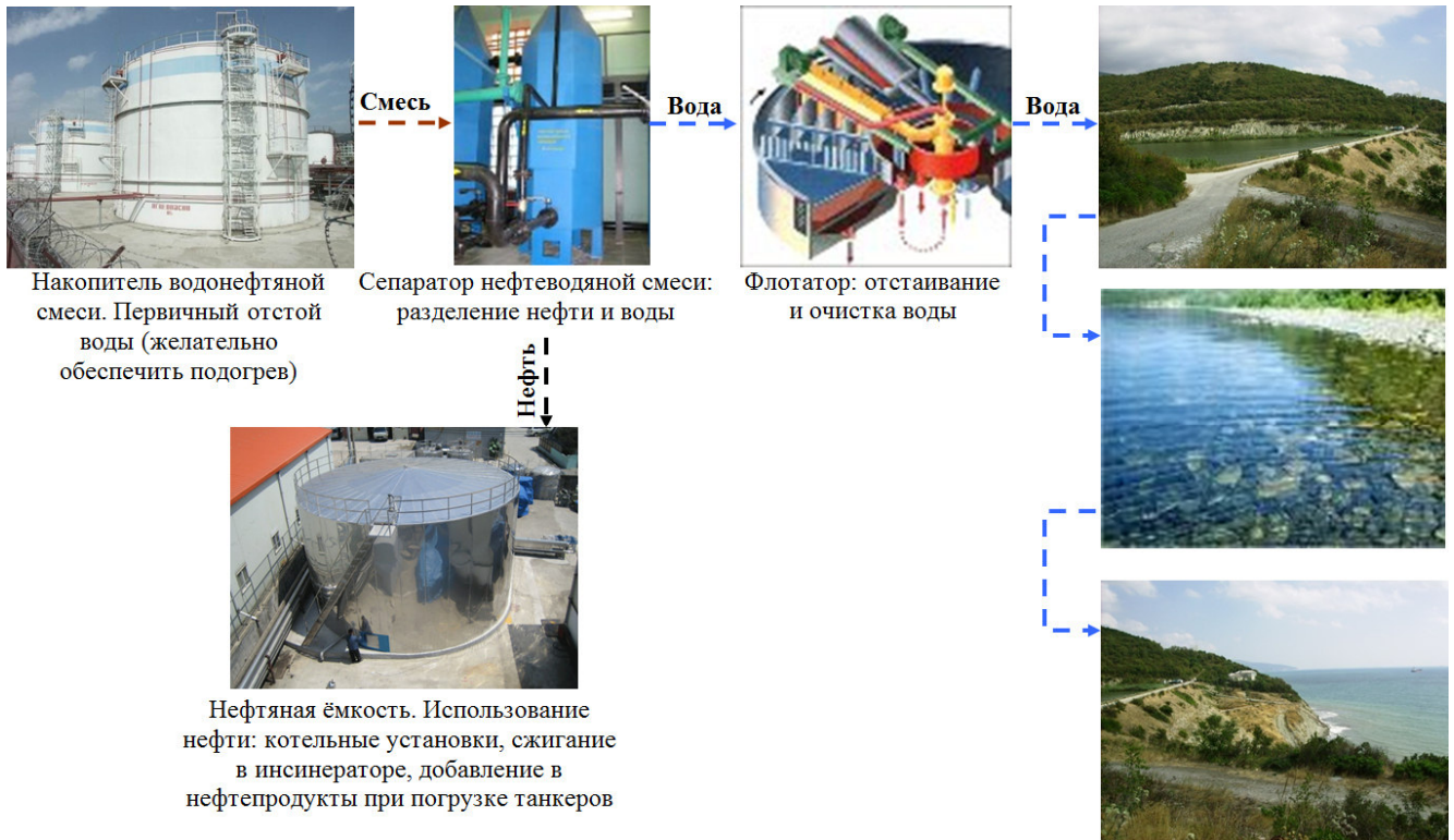
Рисунок 16 - Рекомендуемая схема утилизации нефтеводяной смеси
