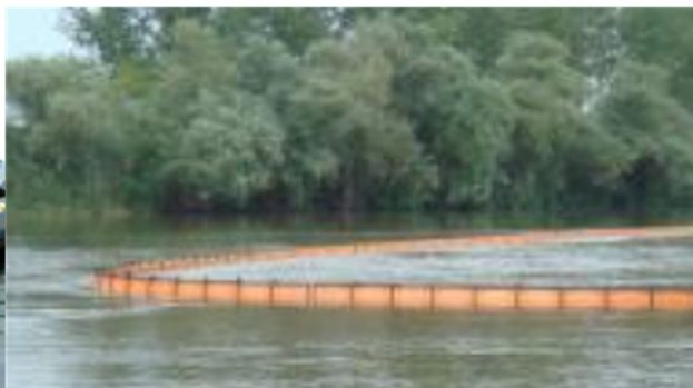
Боновые заграждения для защиты прибрежной зоны и береговой линии "БЗПП 1100"
