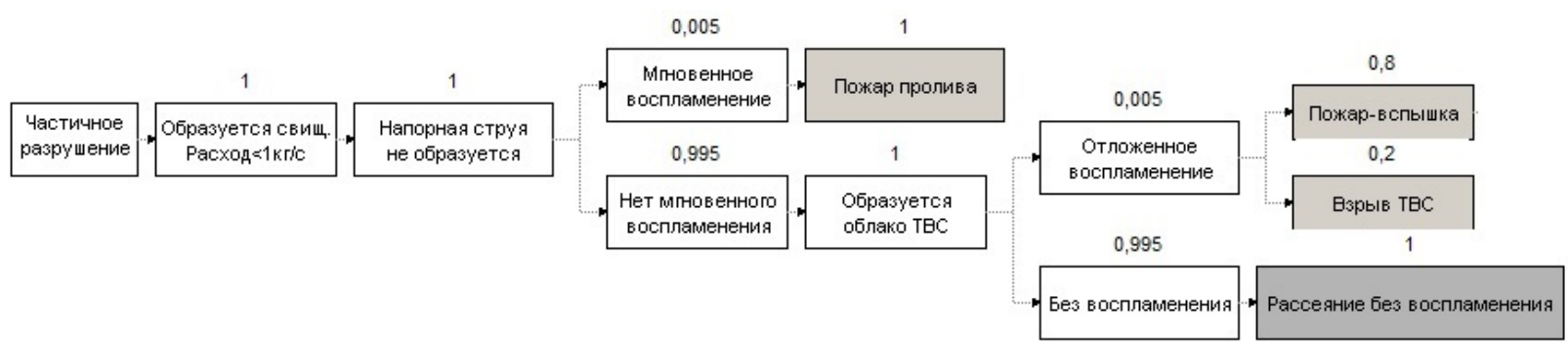
Рисунок 15 – Дерево событий при частичном разрушении на нефтесборных трубопроводах (горючая жидкость и газ)
