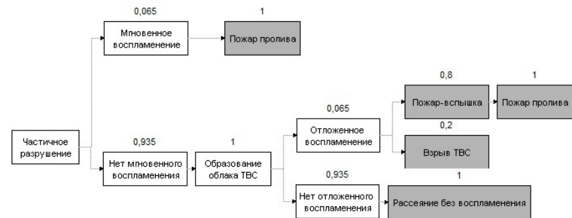
Рисунок 13 – Дерево событий при частичном разрушении выкидных и технологических трубопроводов (горючая жидкость и газ)
