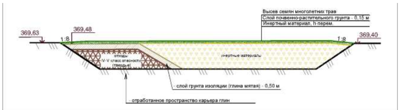
Рисунок 3.2.1 – Схема создания рекультивационного слоя под посев трав
