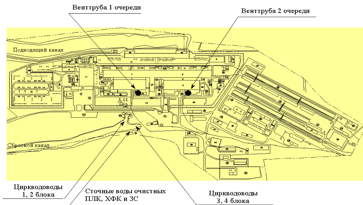
Рисунок 7.3.1.1 - Карта-схема промплощадки Кольской АЭС с указанием источников поступления радиоактивных веществ в окружающую среду
