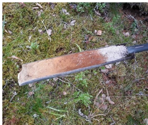
Рис. 6.3.4.3. Отбор проб минеральных горизонтов почвенным буром.
