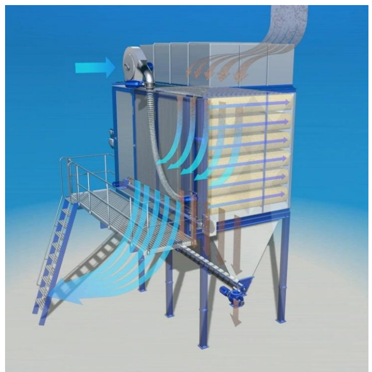
Рис. 4. Схема работы ФВА «МФПР-...-Пр»
