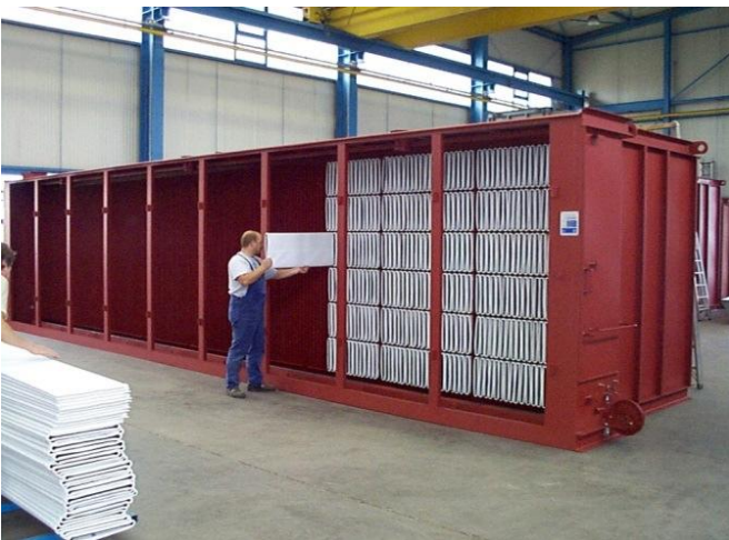
Рис. 6. Заполнение фильтроэлементами камеры
