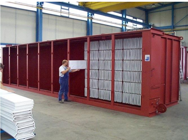
Рис. 6. Заполнение фильтроэлементами камеры
