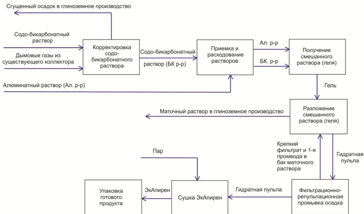
Рисунок 1.2.1-1. Принципиальная технологическая схема производства ЭкАпирена
