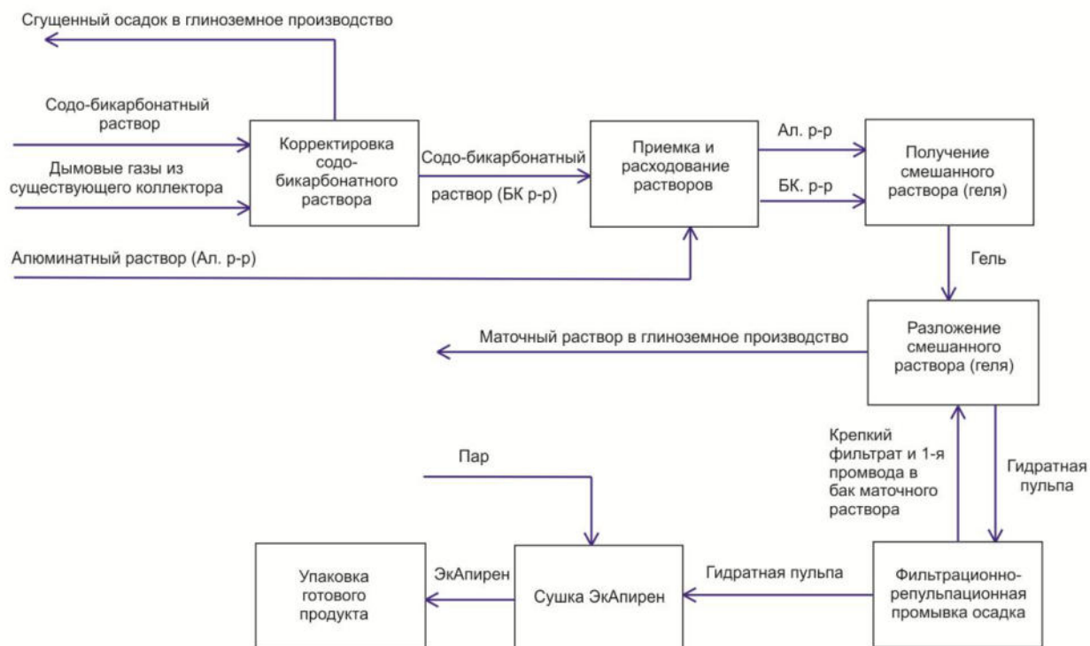
Рисунок 1.2.1-1. Принципиальная технологическая схема производства ЭкАпирена
