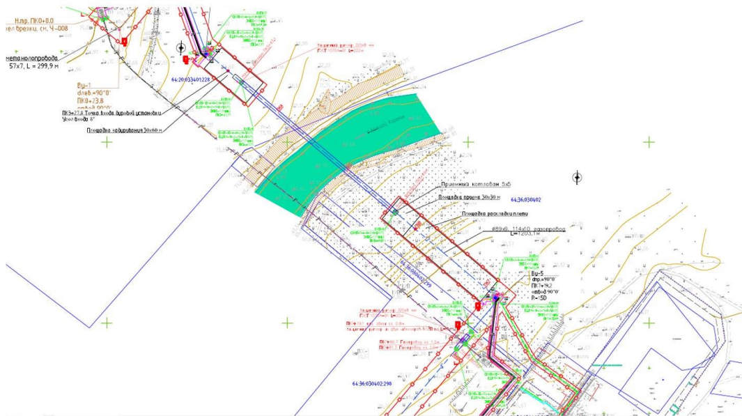
Рисунок 4 – План перехода газопровода через р. Большой Караман (ПК7+0,0-ПК8+0,0) (том 2 СНД/2021-0455-П-ППО-01 лист 2 графической части)
