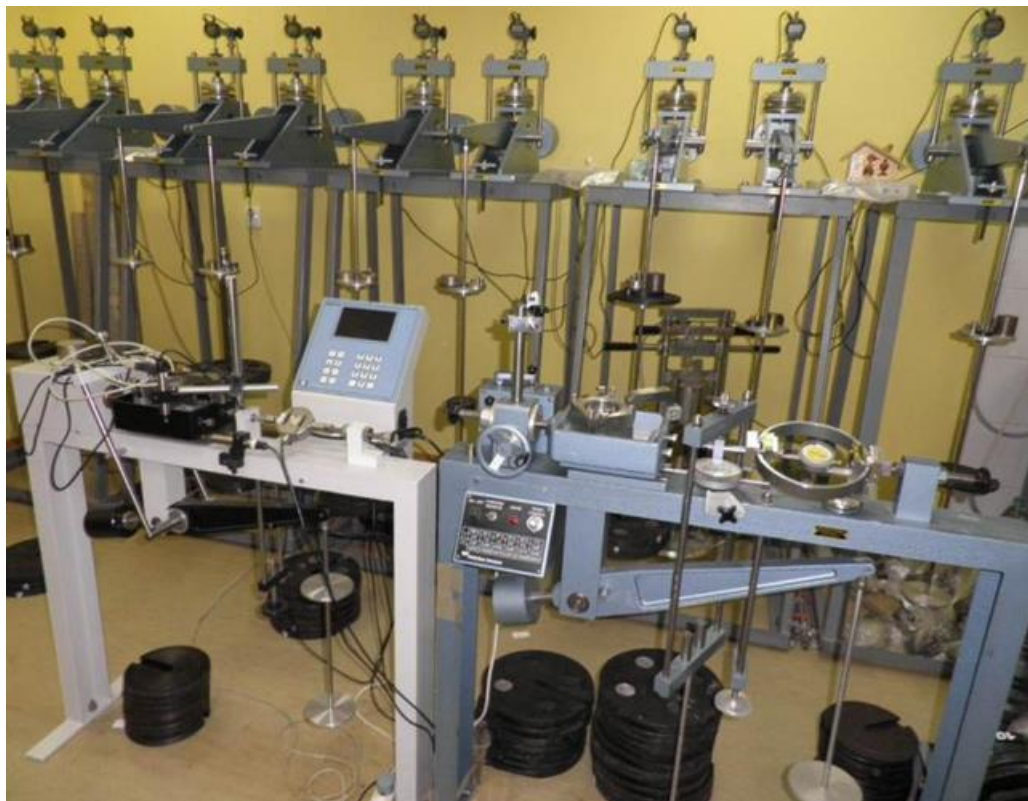
Рисунок 8.7.4. Приборы для исследования прочностных и деформационных свойств грунтов:) сдвиговые (на переднем плане) и компрессионные приборы
