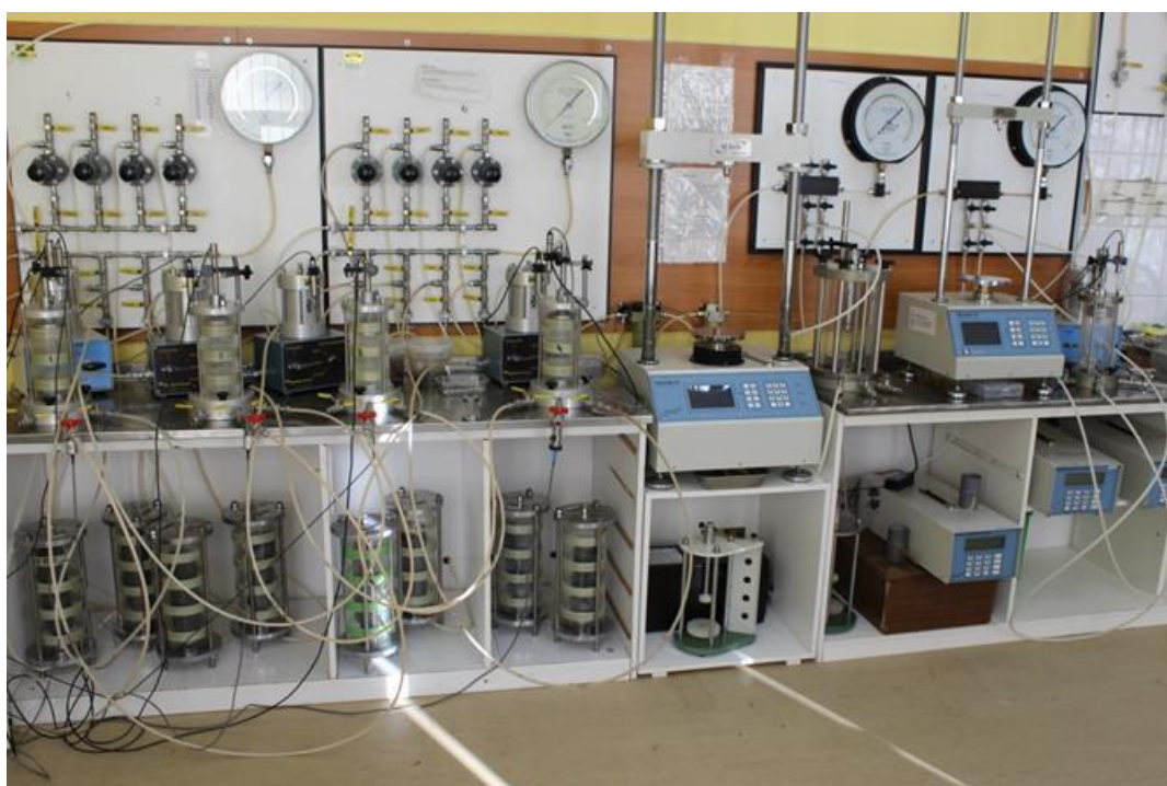
Рисунок 8.7.3. Приборы для исследования прочностных и деформационных свойств грунтов в условиях трехосного сжатия
