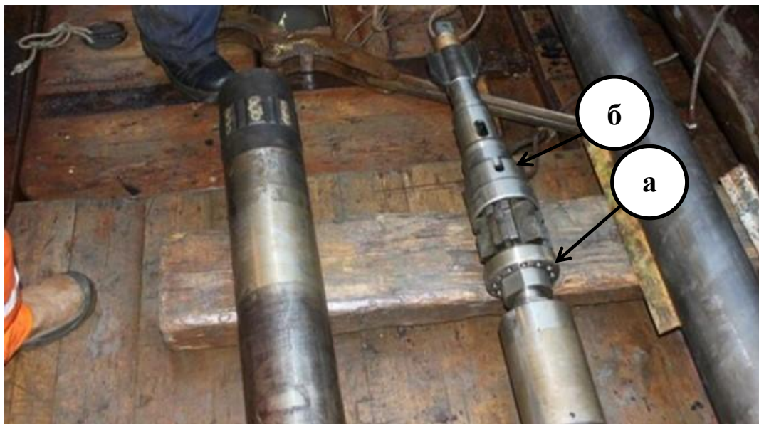
Рисунок 8.5.7. Верхняя часть керноприемного снаряда «Geobor S» с подшипником (а) и овершотом (б) на внутренней керноприемной трубе
