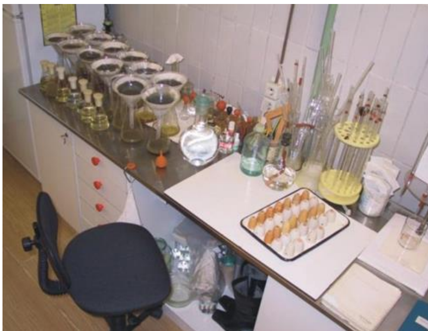
Рисунок 8.7.2. Оборудование для исследования химического состава водной вытяжки из грунтов
