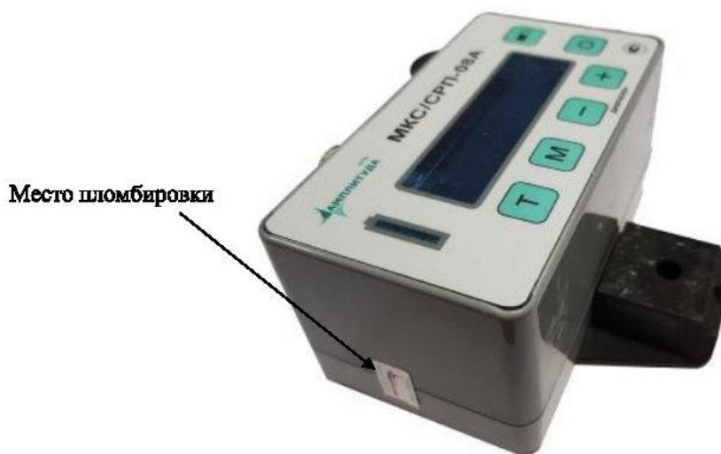
Рисунок 3 – Место установки пломбы на электронном блоке управления
