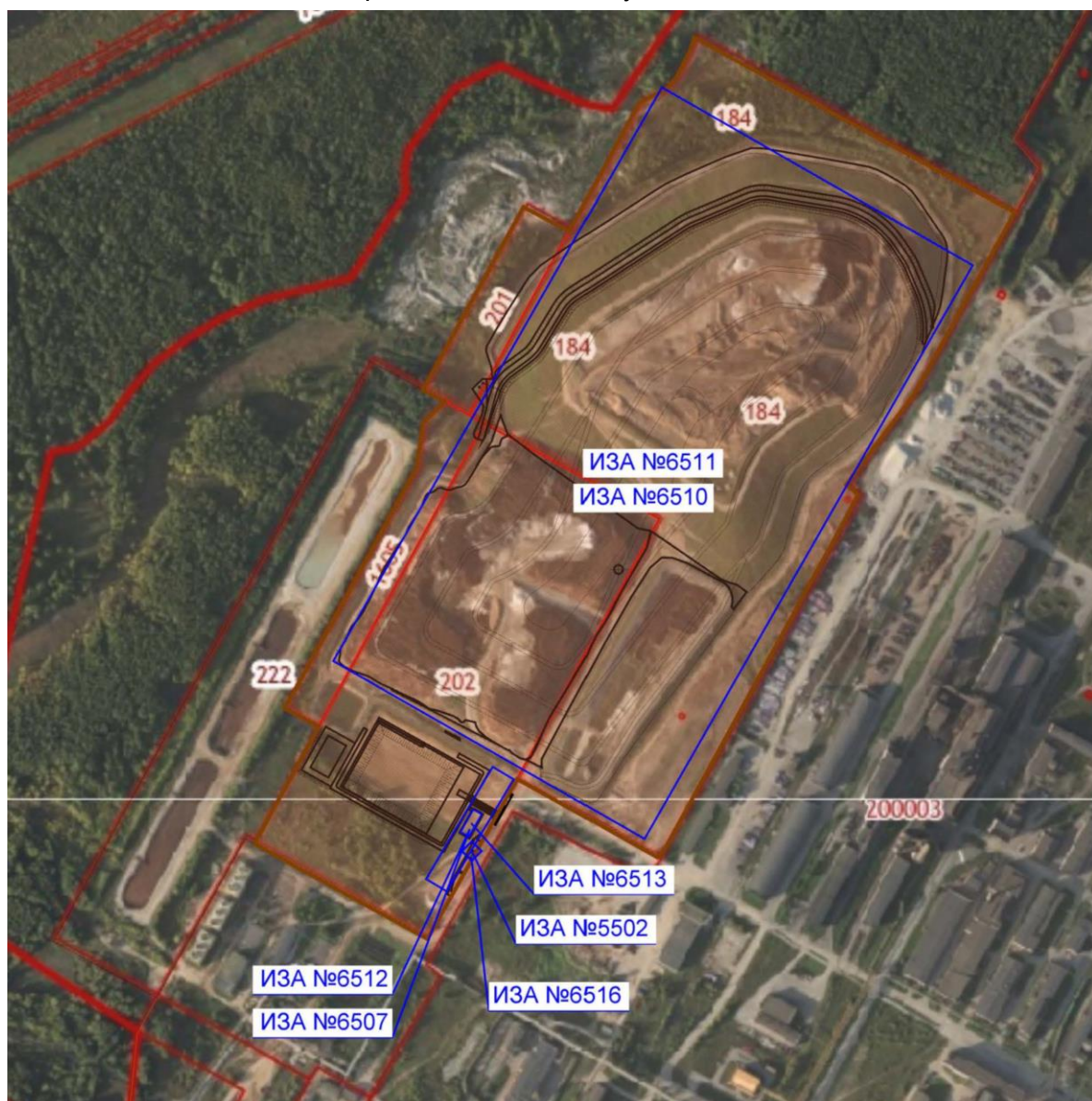
Рисунок 6.8 – Карта-схема расположения источников загрязнения атмосферного воздуха при производстве работ по рекультивации объекта
