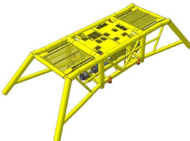
**Рисунок 13 – Общий вид кустового манифольда КМ (без донного основания)**
