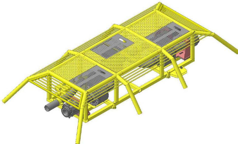
**Рисунок 17 – Общий вид линейного узла подключения**
