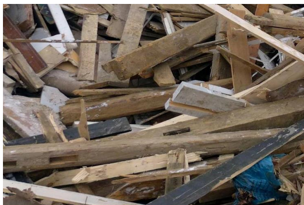
Фото 17. Древесные отходы от сноса и разборки зданий
