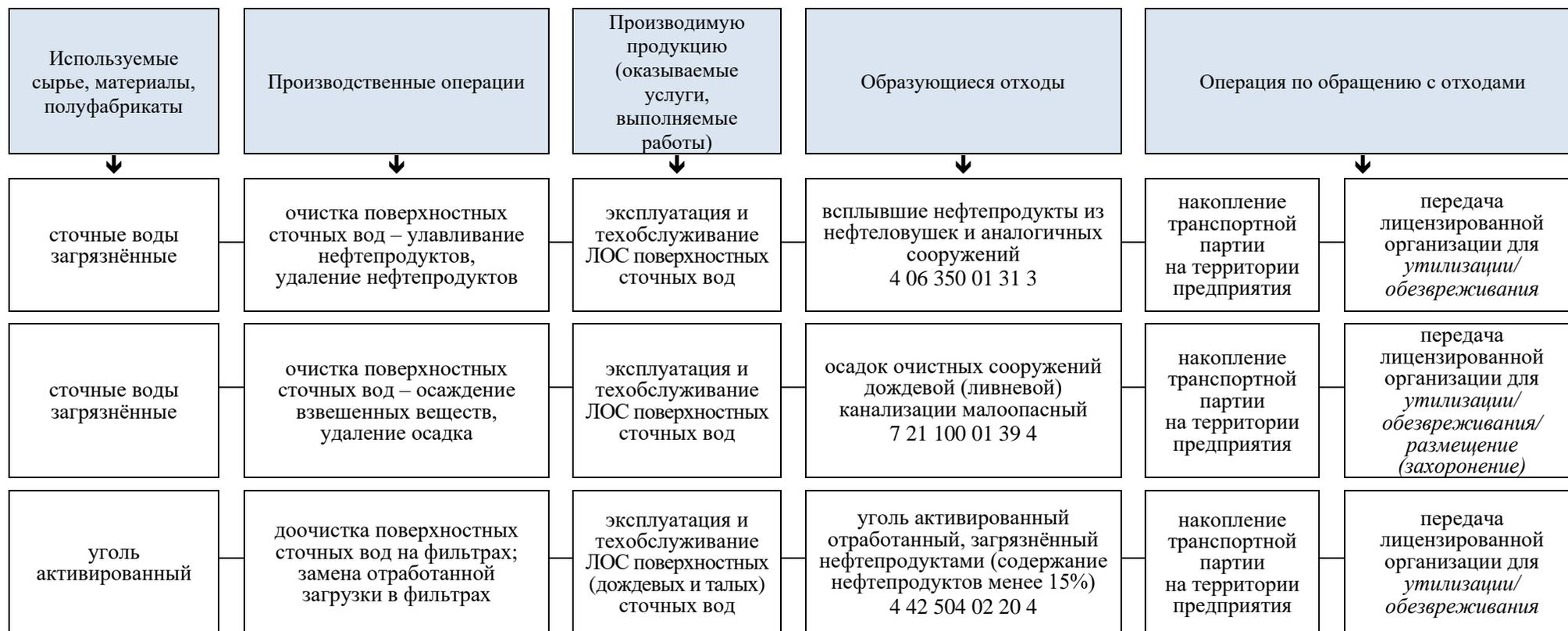
Рисунок 2.8 – Блок-схема технологических процессов ЗАО «Азовпродукт» (эксплуатация и техническое обслуживание локальных очистных сооружений поверхностных сточных вод)
