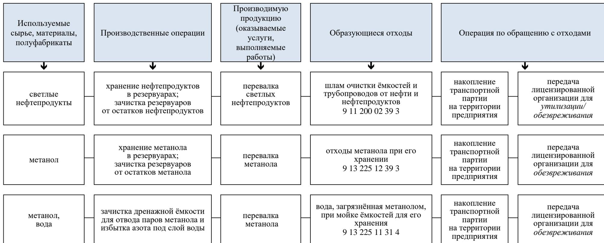
Рисунок 2.1 – Блок-схема технологических процессов ЗАО «Азовпродукт» (перевалка нефтепродуктов и метанола)
