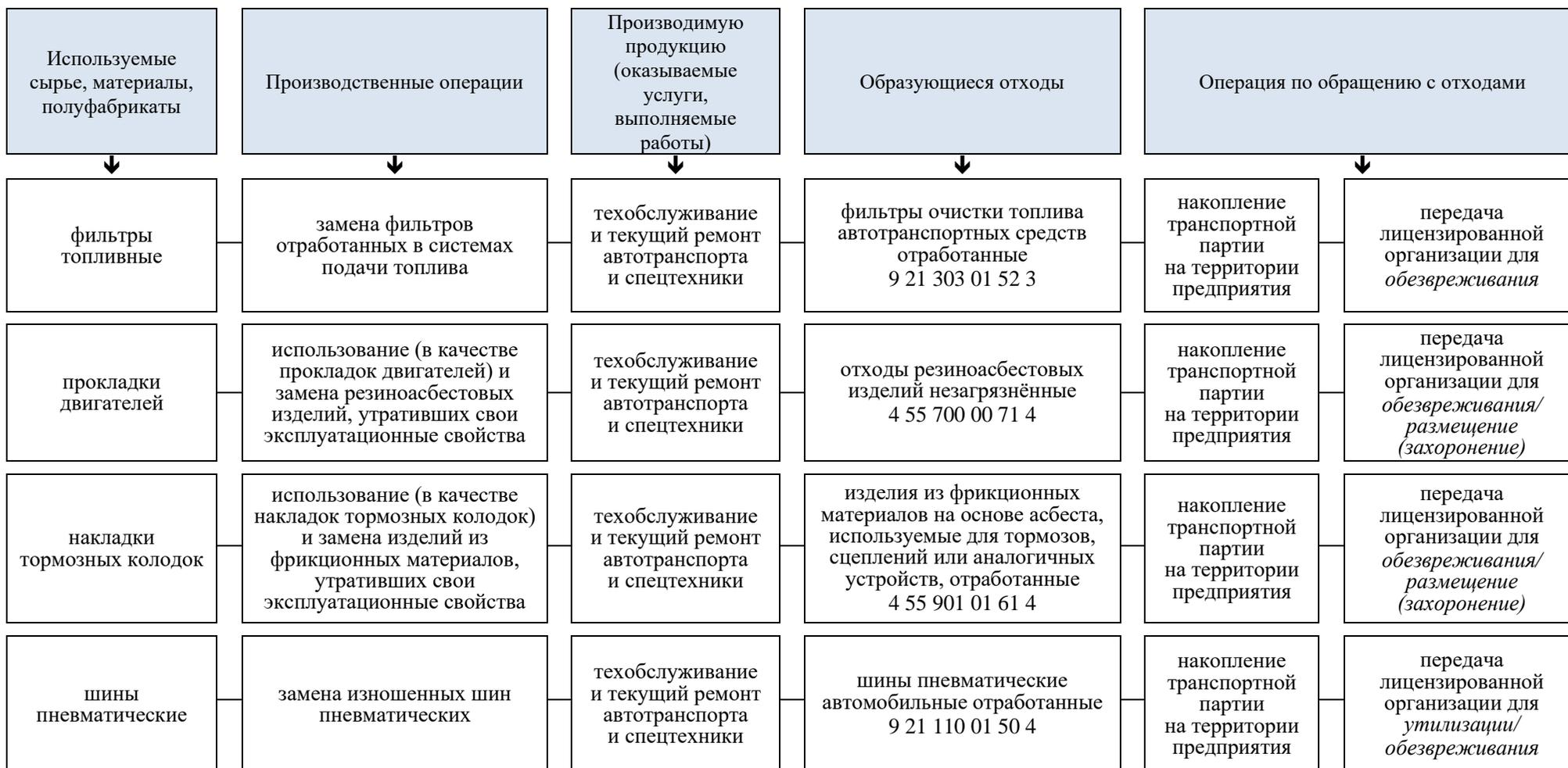
Рисунок 2.6 – Блок-схема технологических процессов ЗАО «Азовпродукт» (техническое обслуживание и текущий ремонт автотранспорта и спецтехники)
