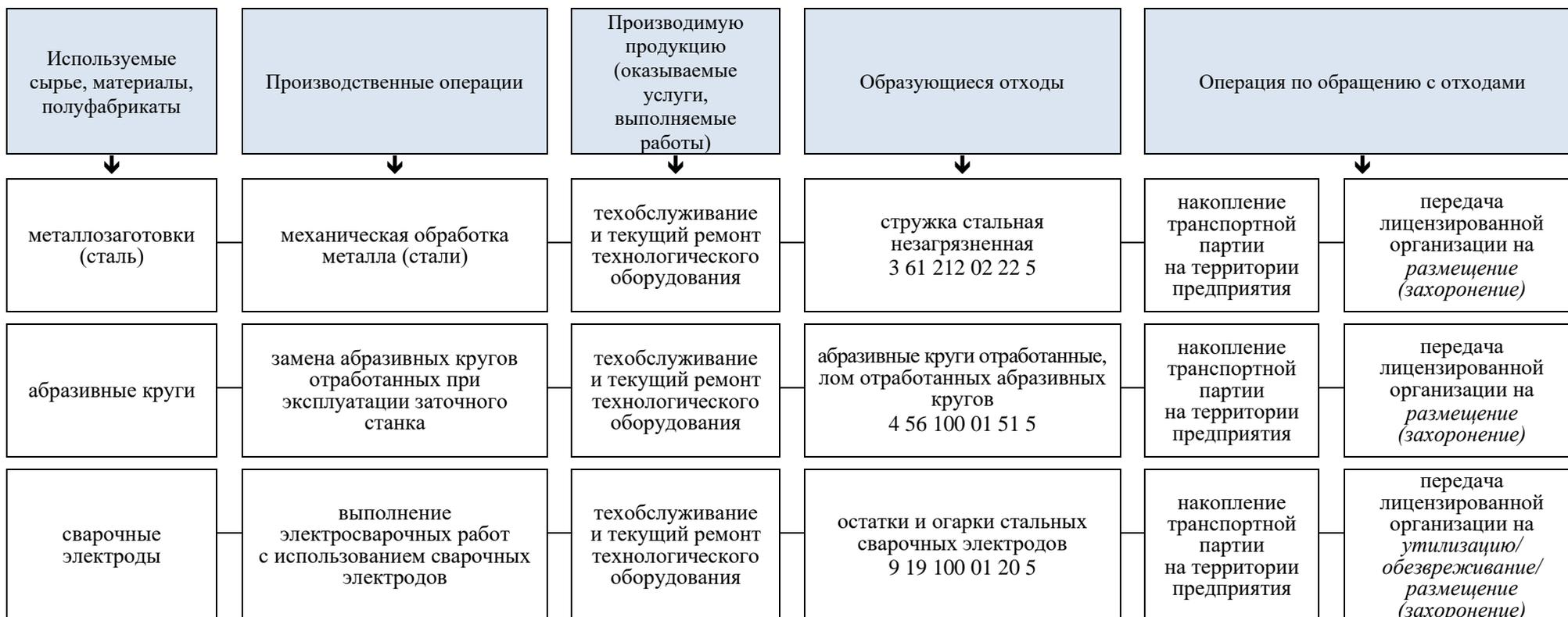
Рисунок 2.4 – Блок-схема технологических процессов ЗАО «Азовпродукт» (техническое обслуживание и текущий ремонт технологического оборудования)
