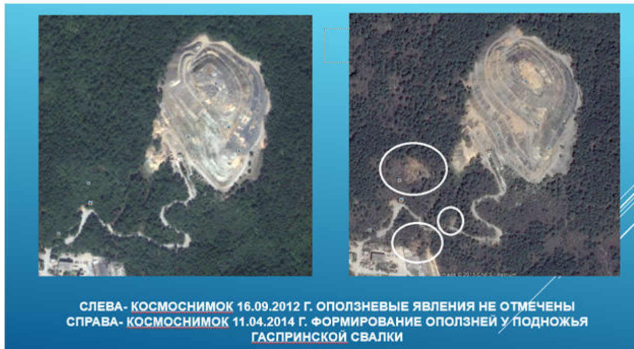
Рис.3.14.1.3. Формирование оползней у подножья полигона
