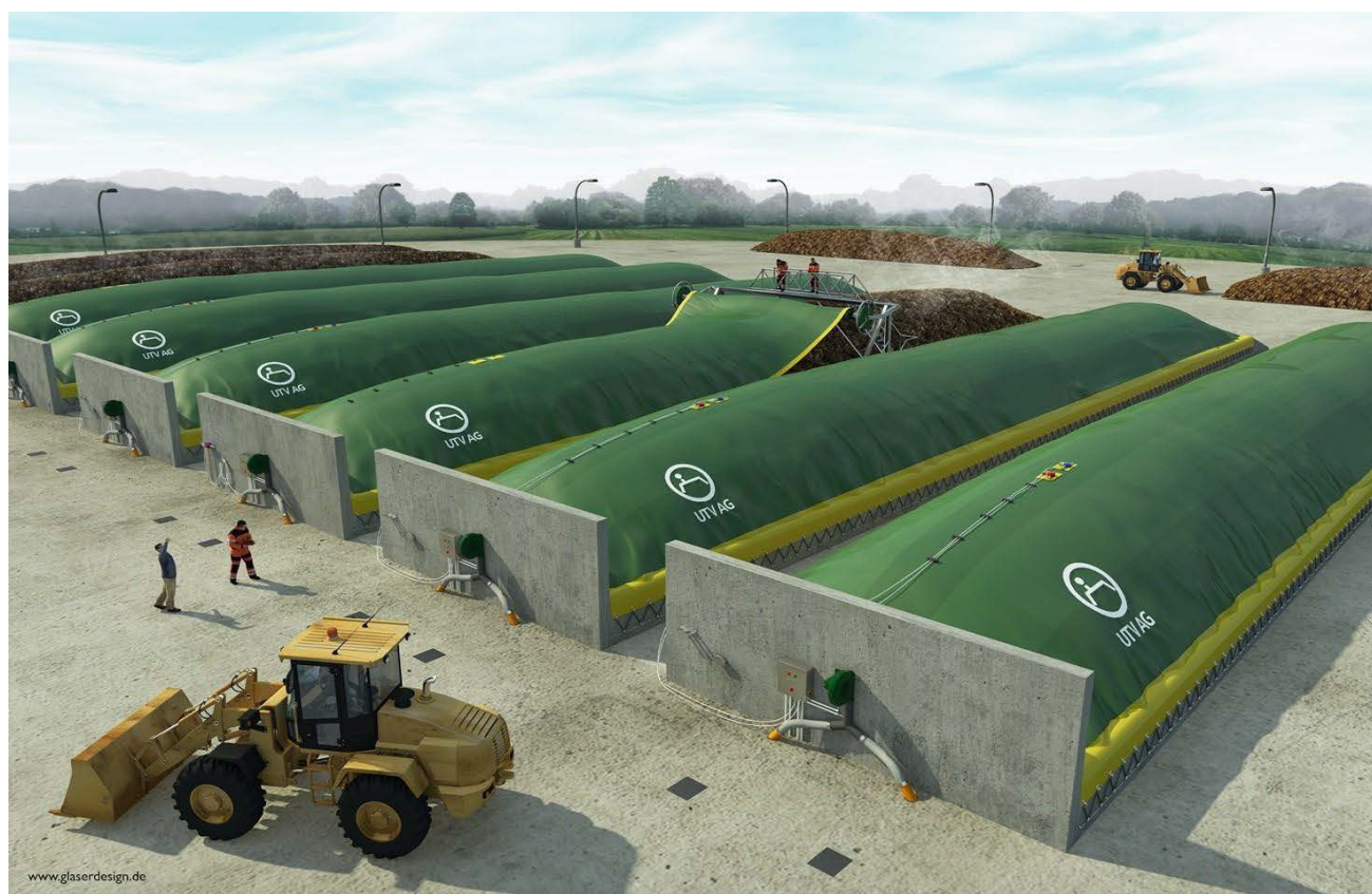
Рисунок 2 – Схема мембранного компостирования
