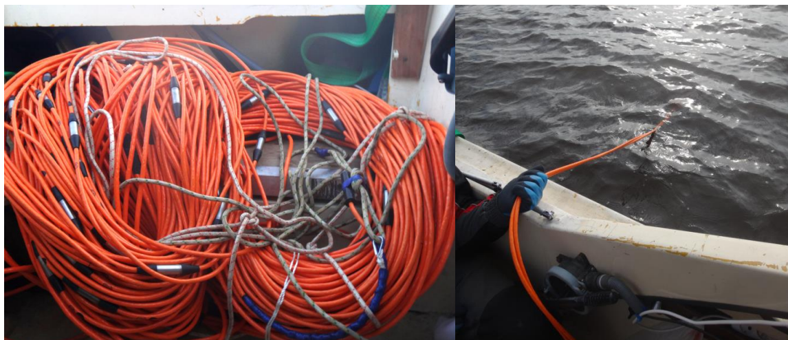
Рисунок 1.3-4 Электроразведочная донная коса на палубе (слева) и во время работ (справа).
