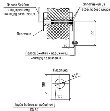
Узел заземления пожарной техники
