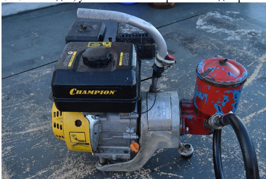
Рис. 3.14 -Силовой агрегат (двигатель и насос) лебедки
