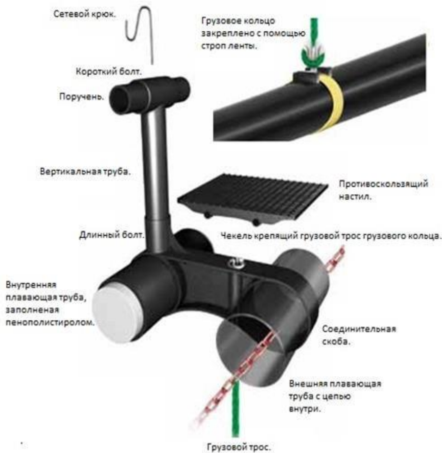
Рис. 1.7 -Конструкция садка в разрезе
