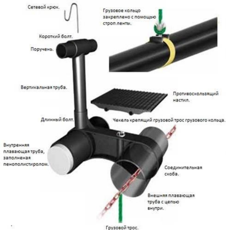
Рис. 3.6 -Конструкция садка в разрезе
