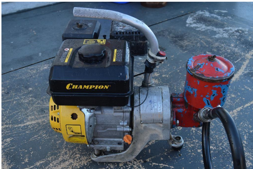
Рис. 1.15 -Силовой агрегат (двигатель и насос) лебедки
