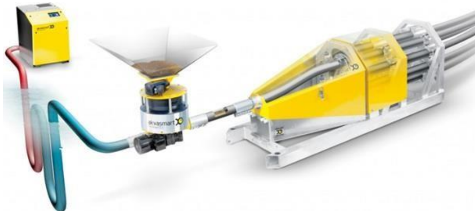
Рис. 1.5 - Слева направо: компрессор, дозатор, селектор, кормовые трубы.
