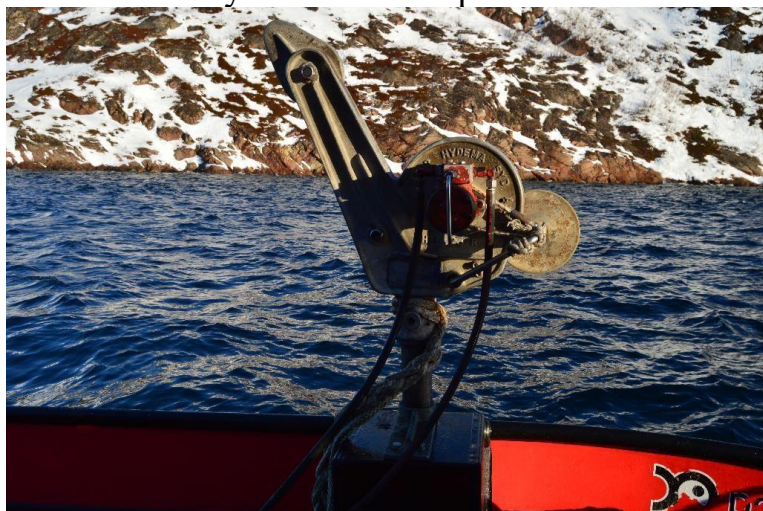
Рис. 3.13 - Лебедка, установленная на рабочей лодке рыбоводов
