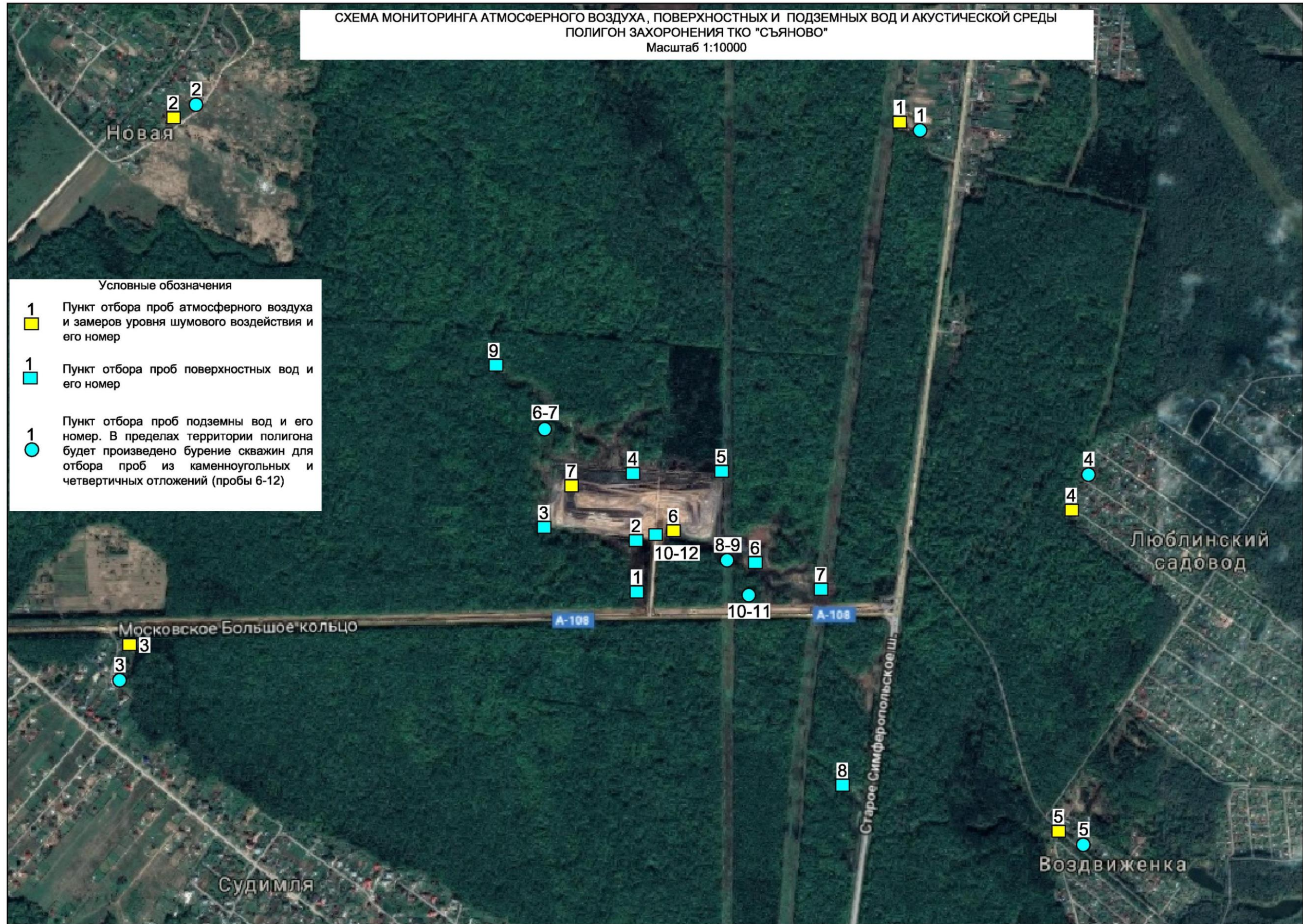
Рис. 8.1. Схема мониторинга состояния атмосферного воздуха, поверхностных и подземных вод и акустической среды
